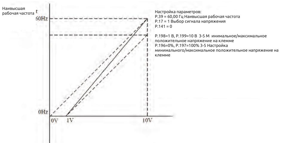
Пример 7: Это пример применения отрицательной настройки наклона зависимости. В промышленности часто используются датчики давления, температуры и расхода. Некоторые из таких датчиков выдают сигнал 10 В при высоком напряжении или высоком расходе. Этот сигнал действует как задание для инвертора для замедления или останова двигателя. Конфигурация, представленная в Примере 8, может хорошо работать в системах такого типа.
