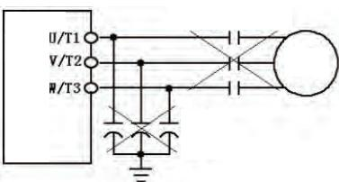
3. Не используйте подачу питания на электромагнитный контактор или на автоматический выключатель без предохранителя для пуска и останова электродвигателя.
