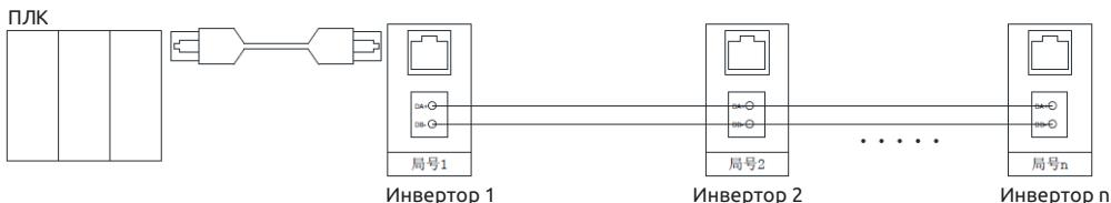
4. Инверторы серии ESQ A500 поддерживают протокол передачи данных Shihlin и протокол передачи данных Modbus.
