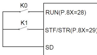
3) Режим 3-проводного управления 1 (с функцией самодиагностики): K0 предназначен для функции ОСТАНОВ, он нормально замкнут. Если его разомкнуть, инвертор остановится. K1 и K2 - это сигналы Вперед и Назад, они нормально разомкнуты. Они указывают, что импульсный сигнал активен, т.е. действует толчковый режим JOG.
