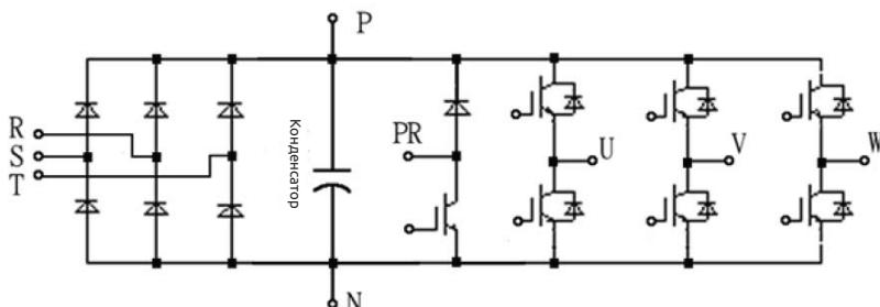
Примечание: На схеме выше в качестве примера показан инвертор габарита А.
