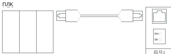
3. Канал связи между задающей положение контроллером (в качестве примера взят ПЛК) и несколькими инверторами.
