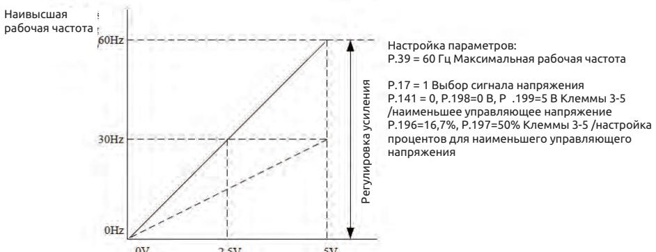
Пример 5: Это пример рекомендуется для устранения настройки рабочей частоты инвертора сигналом, который меньше 1 В в неблагоприятных условиях эксплуатации, так что лучше применить средства снижения шума и подавления наводок.
