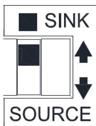
Независимо от типа универсальной входной клеммы всю внешнюю проводку клеммы можно рассматривать как простой выключатель. Если этот выключатель «Вкл», то на клемму подан сигнал управления. Если этот выключатель «Откл», то сигнал управления отсутствует.
