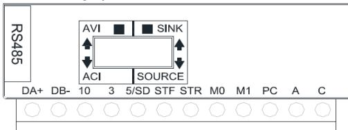
При подключении проводов цепей управления снимите изоляцию с конца провода и подсоедините туда лепестковый наконечник. В случае одного провода просто срежьте изоляцию с провода и закрепите наконечник.
