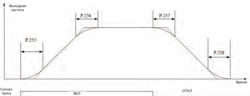
1) Параметры 01-36, 01-37, 01-38 и 01-39 используются для плавного пуска инвертора без ударных нагрузок. Эти параметры также позволяют отрегулировать степень изменяющегося наклона S-рампы ускорения/замедления. При пуске ускорения/замедления по S-рампе инвертор будет ускоряться/замедляться с различной скоростью согласно первичному времени ускорения/замедления.
