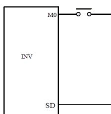
Схема электропроводки для режима ручного цикла
