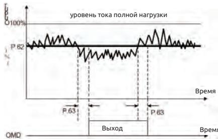
**Примечание:** В этом разделе OMD - это название функции для "клетки универсального цифрового выхода". Смотрите описания параметров 03-10, 03-10 ~ 03-13. Соответствующая электропроводка описана в разделе 3.5.
