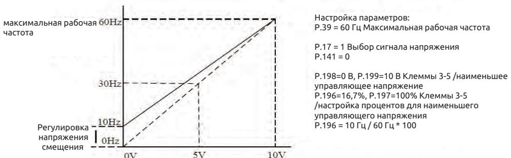
Пример 4: В этом примере для регулировки частоты используется напряжение 0~5V
