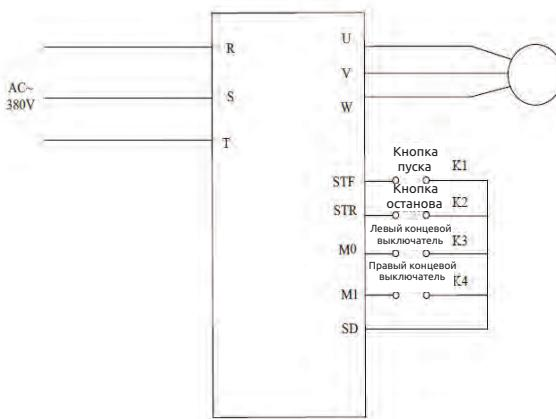
Схема подключения электропроводки
