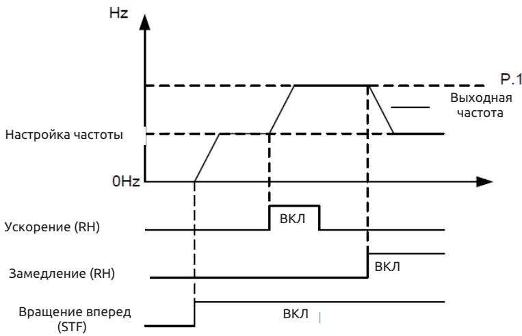
2. Если сигнал ускорения или замедления равен ВКЛ, время ускорения / замедления будет определяться по значению настройки 01-06 (первое время ускорения) и 01-07 (первое время замедления).
