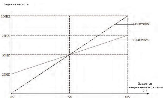
На рисунке выше, если подано 0 В, задание частоты равно 50 Гц - (50 Гц × 50%) = 25 Гц; если подано 5 В, задание частоты равно 50 Гц - (50 Гц × 0%) = 50 Гц; если подано 10 В, задание частоты равно 50 Гц + (50 Гц × 50%) = 75 Гц.
