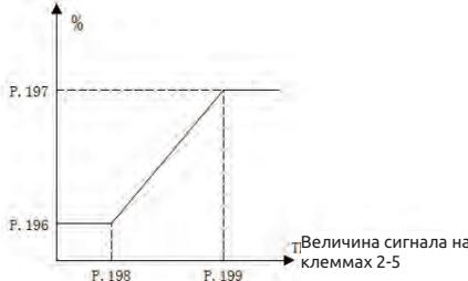
При выборе управления частотой внешним сигналом согласно изложенному выше нужно вычислить отношение значение 02-21 к фактической частоте для входного значения (выбор процентной доли входа напряжения/тока 3-5 при 02-61 = 0).
